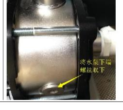
之后将水泵排气、排水螺丝取下放水后。安装好
