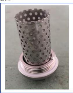
用活动扳手将Y型水过滤器下端的六角逆时针拧下(需用气枪将Y型水过滤器内部滤网上的污垢、杂质吹洗干 净即可
